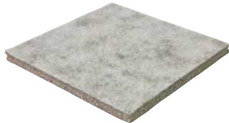
Base resiliente amortiguante de polímero elástico y minerales con doble capa anti-rotura por tracción. Solución que permite desacoplar la instalación de suelo cerámico del forjado consiguiendo gran reducción del ruido de impacto sin necesidad de recrecido. Aislamiento a ruido de impacto 14dB. Densidad 1300kg/m<sup>3</sup>. Buen transmisor con calefacción radiante. Rollo 4m<sup>2</sup>.
