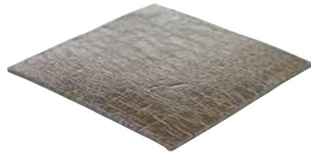
Liviano y fácil de transportar y de instalar. Film de aluminio. Actúa como barrera de vapor. Protege la instalación superficial contra la humedad. Mejora la estabilidad dimensional del producto y proporciona una transmisión más eficiente del calor en suelos radiantes. Celda abierta, no se degrada con el paso del tiempo. Aisla a ruido de impacto 20dB, reduce un 21% el ruido de pisadas. Material base látex natural, libre de fenol y formaldehído. Rollo 15m<sup>2</sup>.
