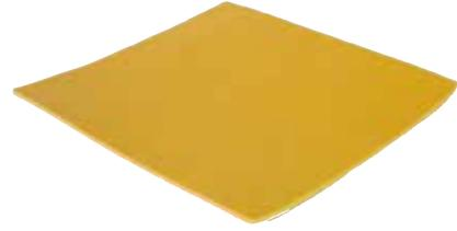
Base resiliente amortiguante de látex fabricada mediante tecnología Airfit®, proporcionando gran rendimiento en la reducción de ruido de impactos (IS), y notable reducción del ruido de pisadas un 21% (RWS). Celda abierta no se degrada con el paso del tiempo. Aislamiento a ruido de impacto 20dB. Material base látex natural, libre de fenol y formaldehído. Rollo 15m<sup>2</sup>.
